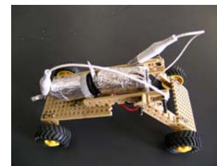
木炭アルミ電池を搭載した模型自動車
