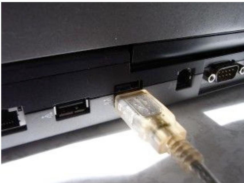
パソコン側。背面の USB ポートに接続しています。
